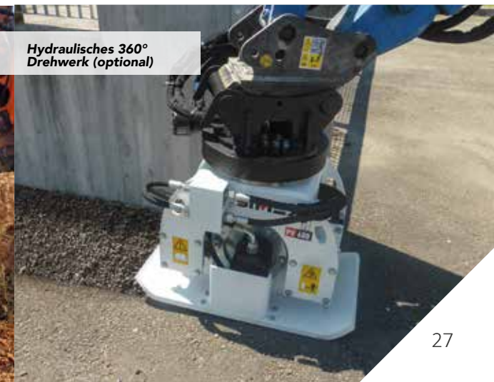
Verdichtung von Gebäudefundamenten
